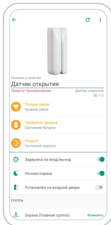
Рисунок 12.2 – Экран настройки радиоустройства с сервисными и тревожными событиями
