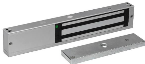
Электромагнитный замок ST-EL324DL-SL предназначен для запирания дверей, контролируемых СКУД, а также дверей эвакуационных выходов. Корпус замка имеет свободное место для установки автономного контроллера управления доступом, например, ST-SC101. Доступный габарит 55x43x23 мм.
