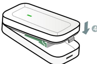
Рисунок 6.5 — Закрытие корпуса радиоустройства
