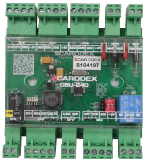
Рисунок 6.3.1 Контроллер управления турникетом «СВU-240» Dip-переключатели
