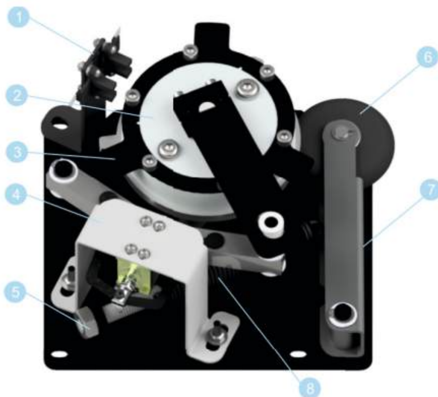
Рис. 6.2.1 - Устройство механизма турникета
