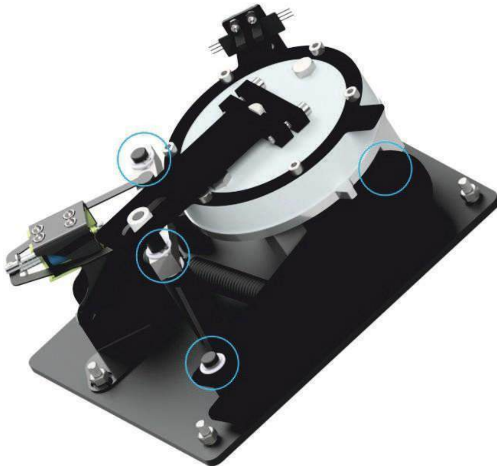
Рисунок 12.5.1 - Места смазки подвижных частей
