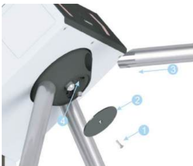
Рисунок 7.5.1 - Установка стандартной преграждающей планки
