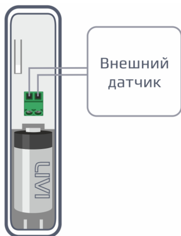
Рисунок 8.1 – Схема подключения внешнего проводного геркона/ШС
