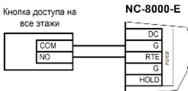
Рисунок 4. Схема подключения кнопки запроса на выход
