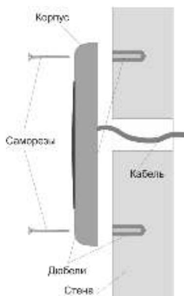
Рисунок 3. Крепление PR-EN05
