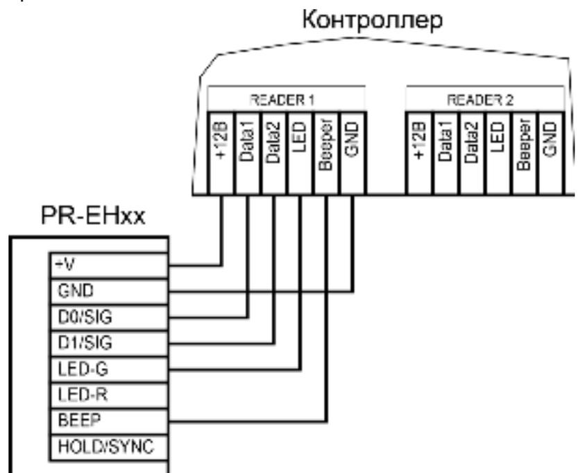
Рисунок 9. Подключение считывателя в режиме Wiegand
