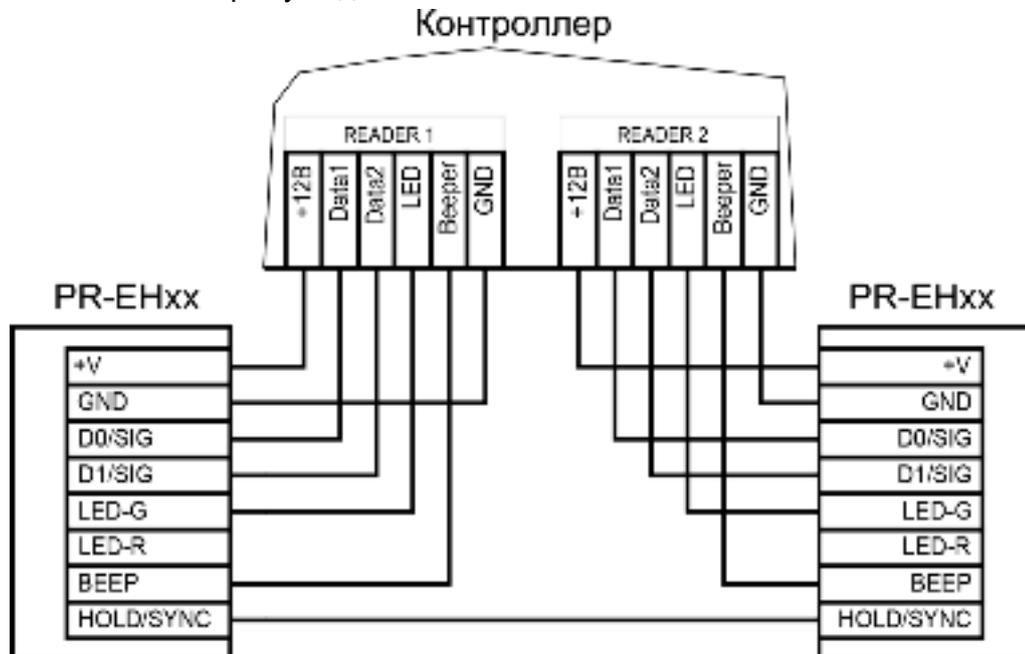
Рисунок 5. Синхронизация считывателей, подключенных в режиме Wiegand
