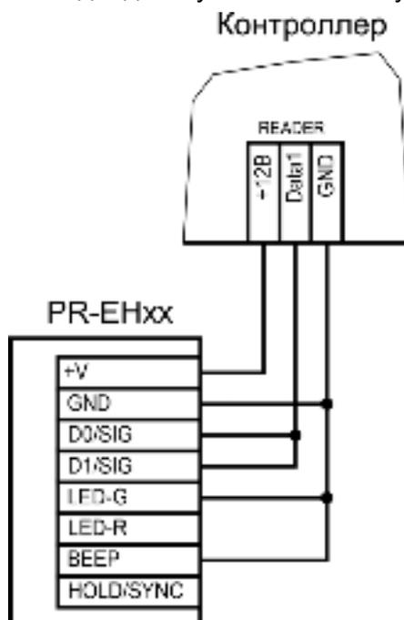
Рисунок 8. Подключение считывателя в режиме Touch Memory
