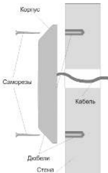
Рисунок 2. Крепление PR-EN03
