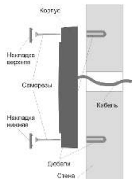
Рисунок 4. Крепление PR-EN09
