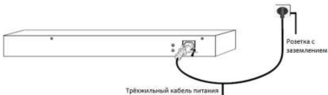
Рисунок 2.8 Заземление с использованием трёхжильного кабеля питания
