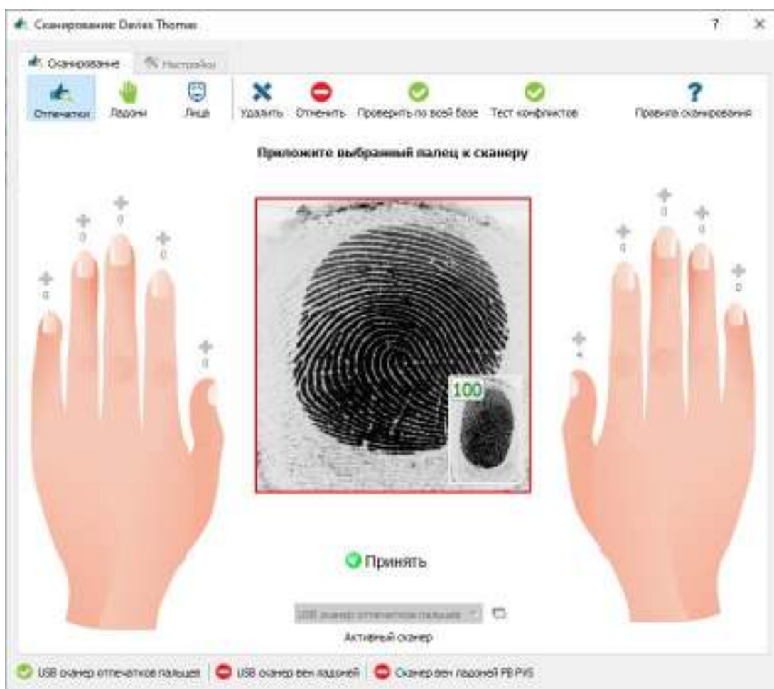
Рисунок 10 – Регистрация отпечатка пальца в ПО Biosmart-Studio с помощью оптического сканера отпечатков пальцев FS-80
