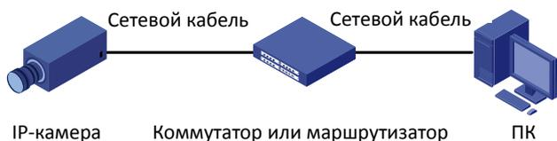
Чтобы подключить сетевые интерфейсы камеры к коммутатору или маршрутизатору, используйте кабель с экранированными витыми парами (STP).
