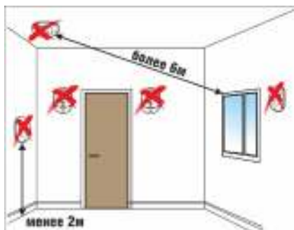
Рисунок 2.2.3.2.6 НЕрекомендуемые места установки извещателя
