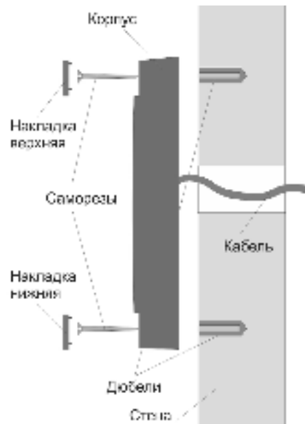
Рисунок 4. Крепление считывателя PNR-P19
