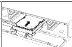
Рисунок 2-9 Вставьте жесткий диск
