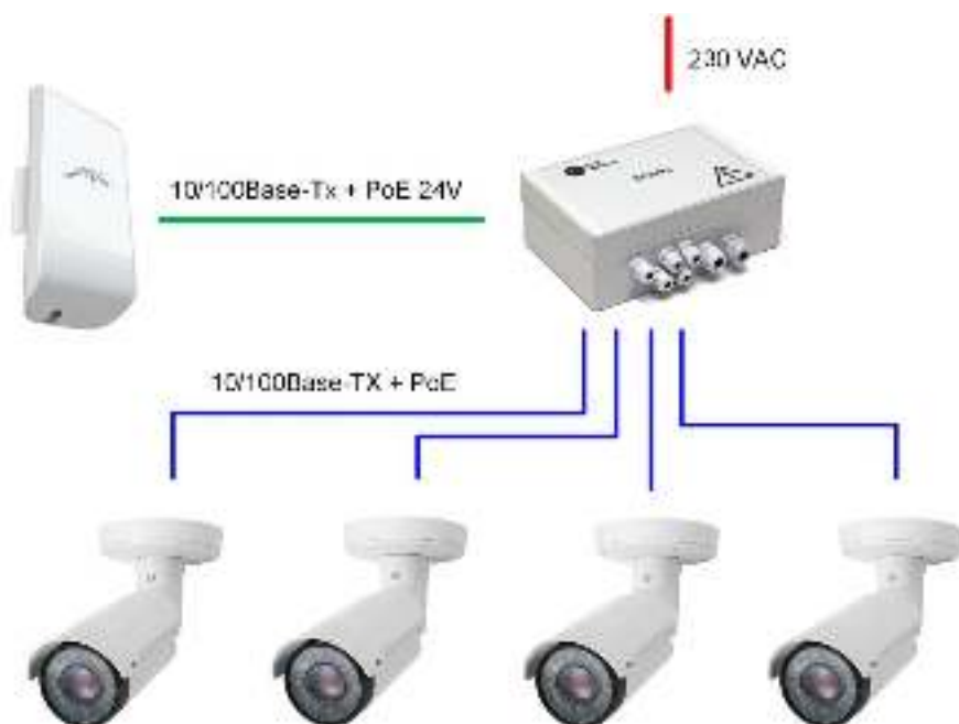
Рисунок 1.2 - Схема подключения PSW-1-45-WiFi по Wi-Fi
