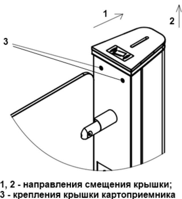
Рисунок 13 – Снятие верхней крышки картоприемника
