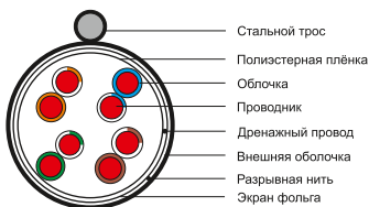
Рисунок 8 – Конструкция кабеля типа F/UTP (со стальным тросом)
