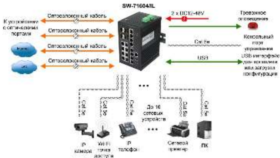
Рис.7 Типовая схема подключения коммутатора SW-71604/IL
