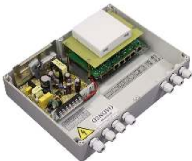
Рис. 2 Уличный коммутатор SW-80402/WL, внешний вид внутри
