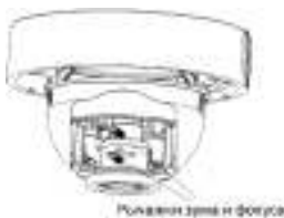
Рисунок 2-14 Рычажки регулировки зума и фокуса
