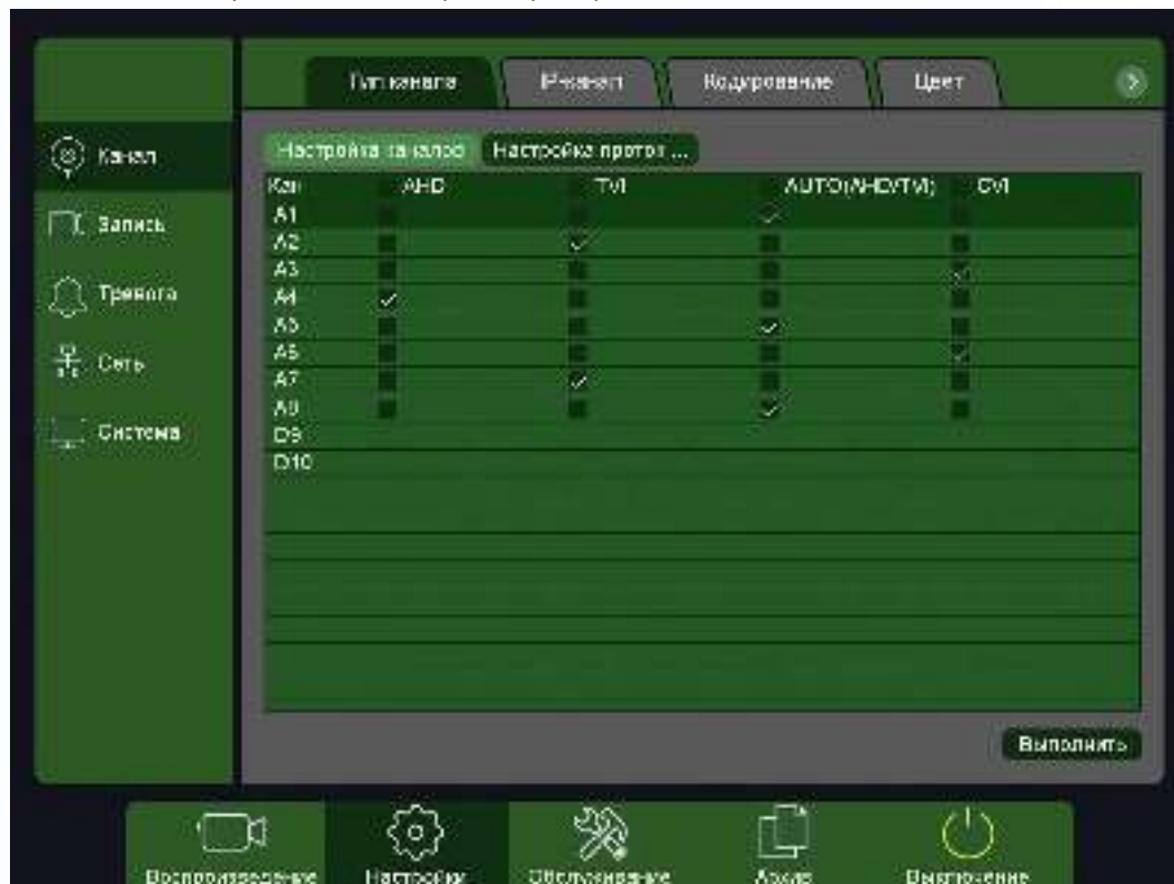
Настройка каналов регистратора TSr-UV0811 Eco, UV0812 Eco:
