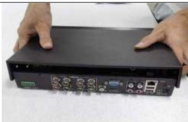
Шаг 3: Снимите верхнюю крышку
