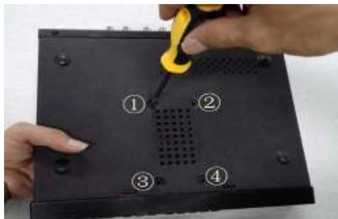
Шаг 6: Зафиксируйте жёсткий диск на держателе при помощи четырёх винтов
