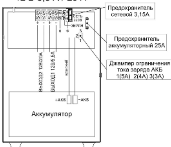
Рис.1 Расположение коммутационных элементов.
