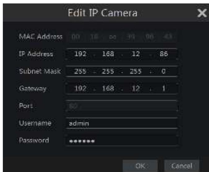
Для редактирования параметров добавленной камеры нажмите кнопку . В окне Edit IP Camera [Редактировать IP камеру] введите новое название IP камеры, IP адрес, порт, имя пользователя и пароль доступа к камере. Для проверки правильности ввода информации нажмите кнопку **Test [Проверить]**. Нажмите кнопку ОК для сохранения настроек. Изменить IP адрес камеры можно только в том случае, если камера находится в режиме онлайн. Для продолжения нажмите кнопку **Next [Далее]**.
