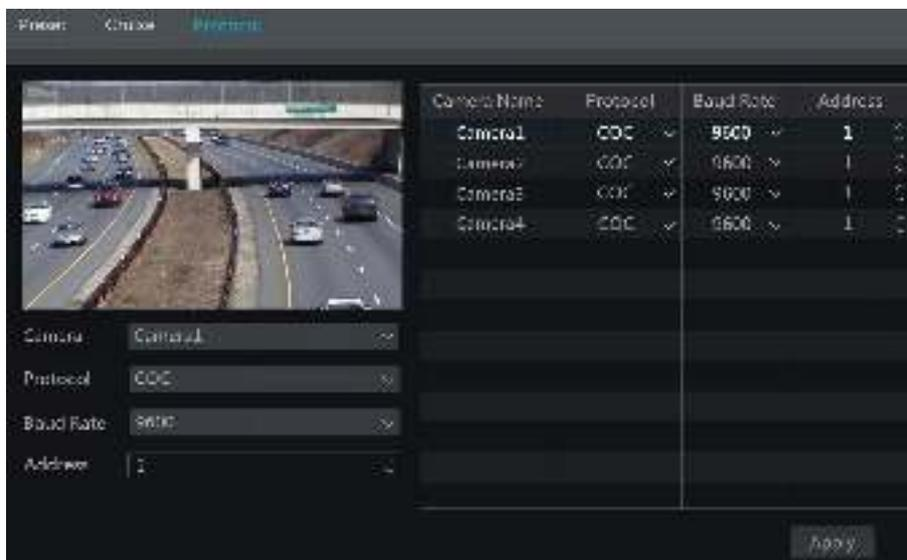
Выберите камеру, а затем укажите протокол, скорость передачи данных и адрес камеры в соответствии с настройками этой PTZ-камеры.
