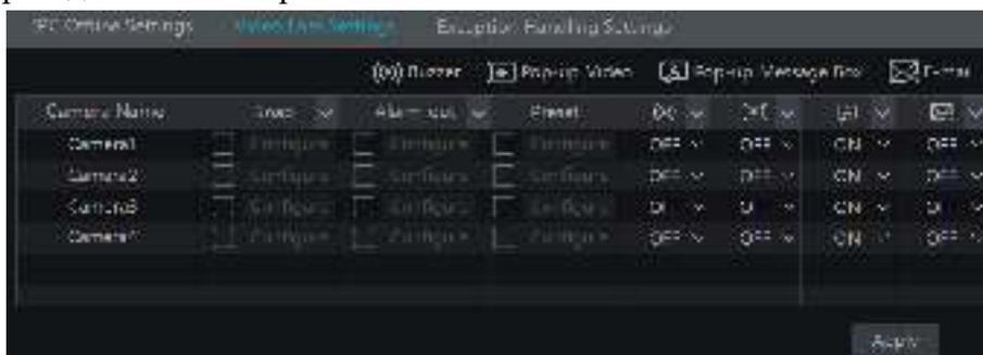
2. Включите или отключите параметры «Snap» [Снимок], «Alarm-out» [Тревожный выход], «Preset» [Пресет], «Buzzer» [Зуммер], «Pop-up Video» [Всплывающее видеоокно] и «E-mail».
