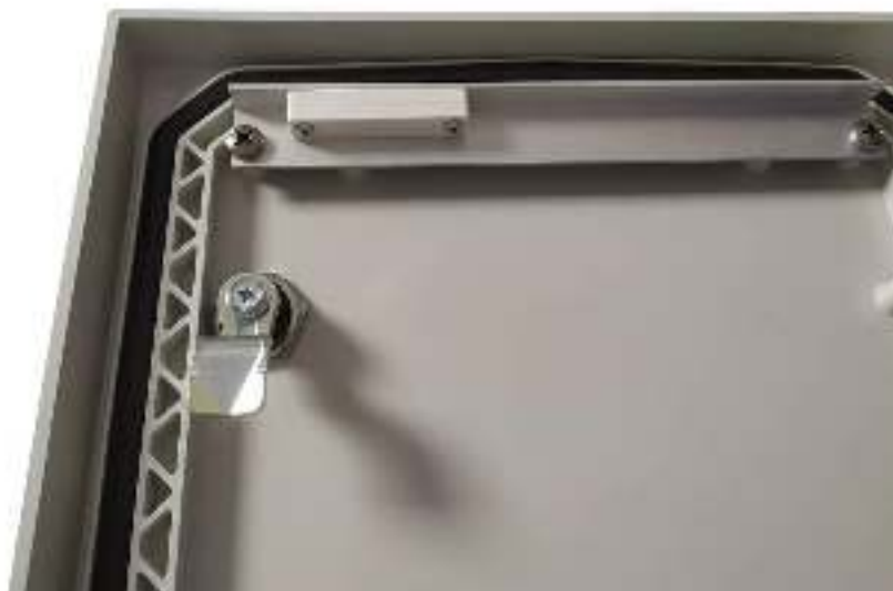
Рисунок 3.6.1 - Датчик вскрытия на крышке коммутатора
