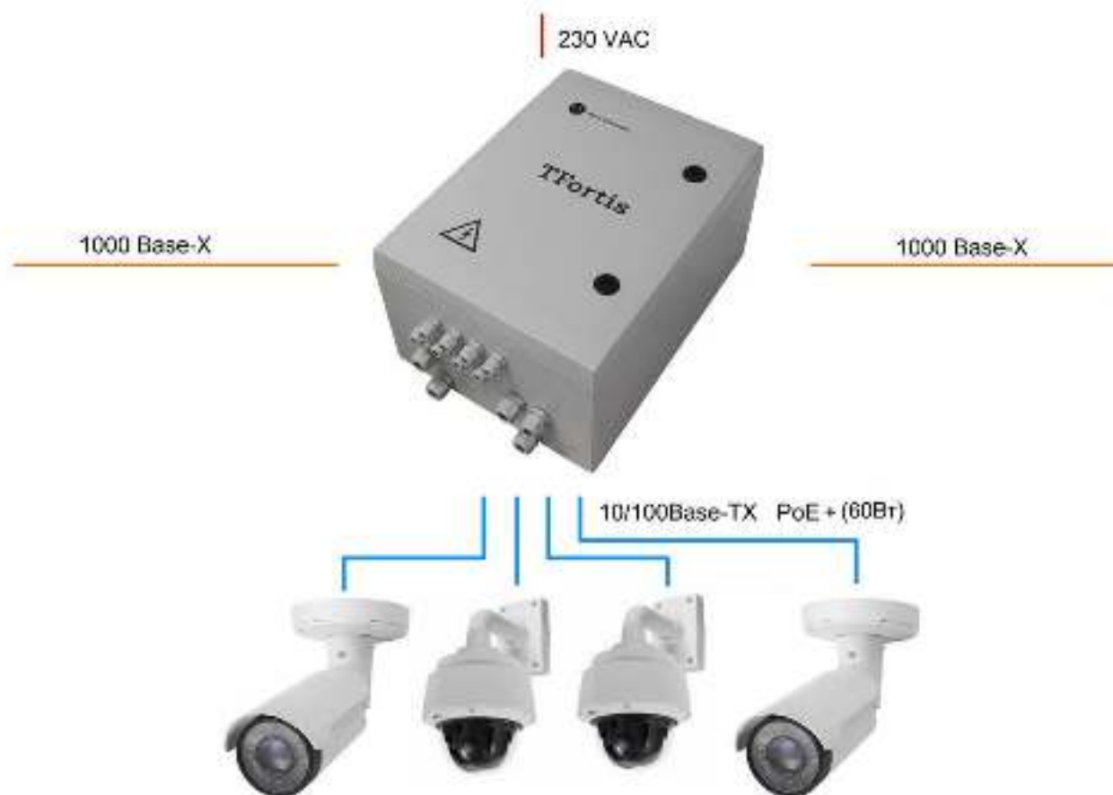
Рисунок 1 - Схема подключения PSW-2G+Box
