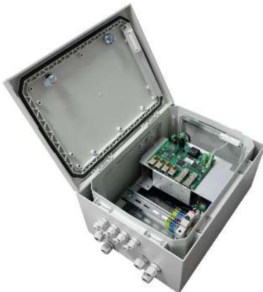
Рисунок 3.1.2 - PSW-2G+Box - вид внутри
