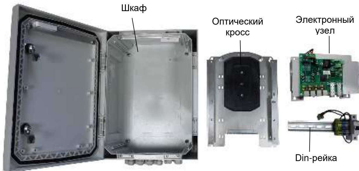
Рисунок 3.1.3 – Основные элементы коммутатора
