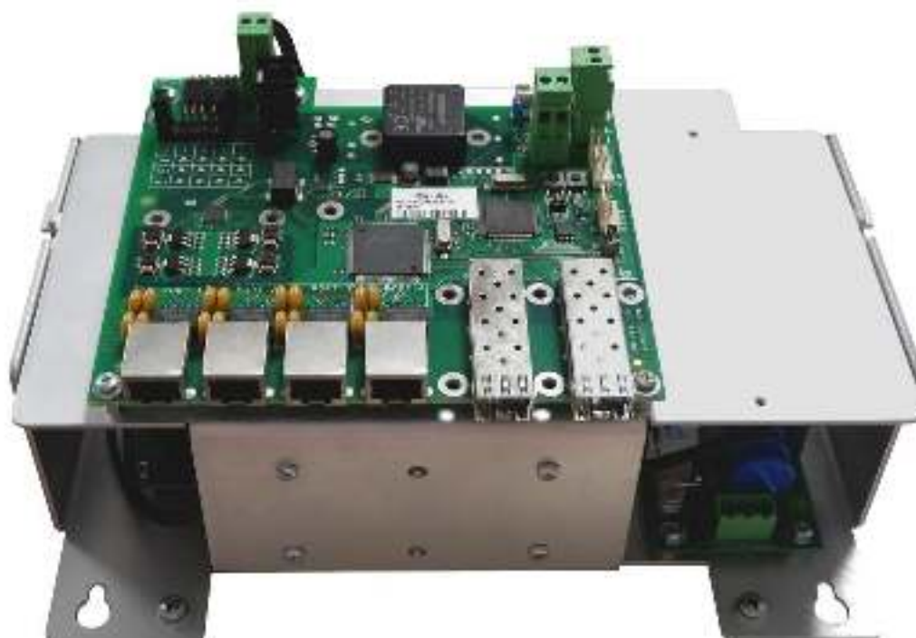
Рисунок 3.4.1 - Плата коммутатора и блоков питания
