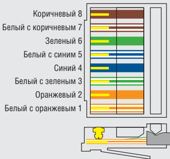
Рисунок 6. Обжимка кабеля UTP
