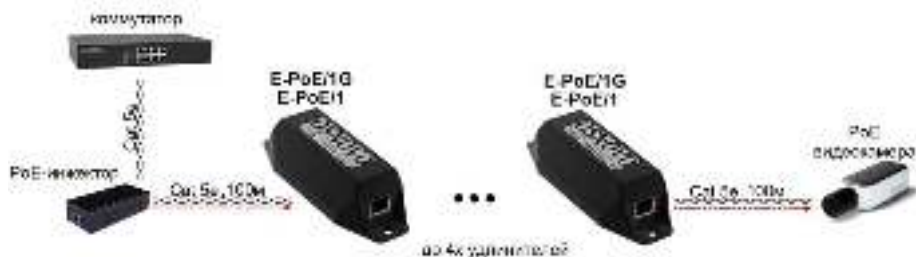
Рис. 6 Схема подключения удлинителей на примере модели E-PoE/1, E-PoE/1G
