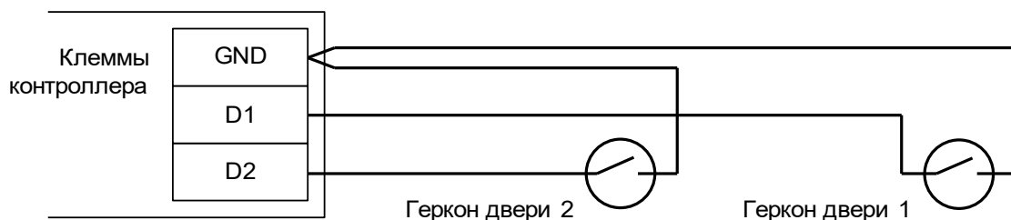
Рисунок 38. Подключение датчиков открытия дверей..
