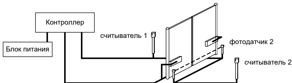
Рисунок 27. Пример автоматизации ворот с использованием карточек или меток.
