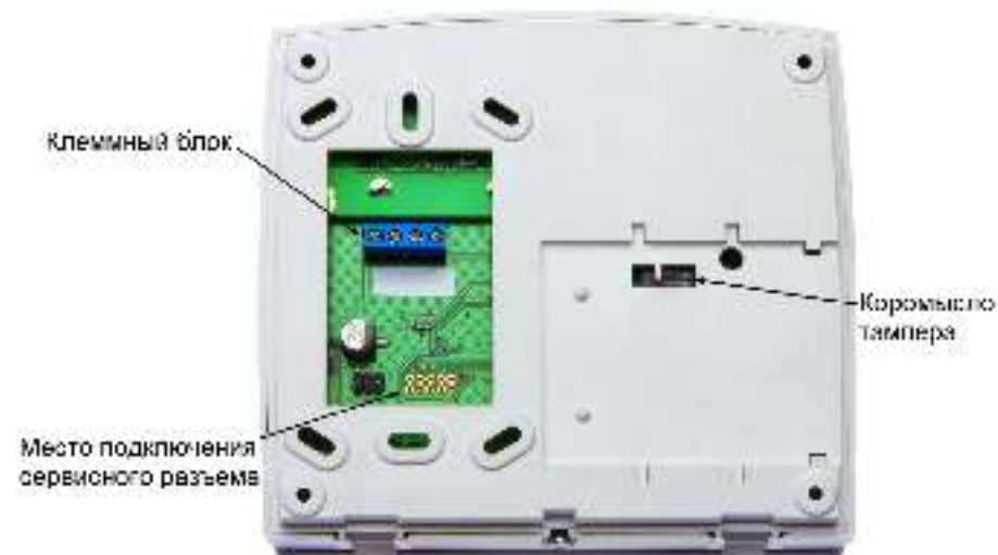
Рисунок 2. Вид клавиатуры АКД-01 сзади
