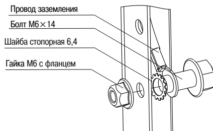
Рисунок 20 – Узел заземления на стойках
