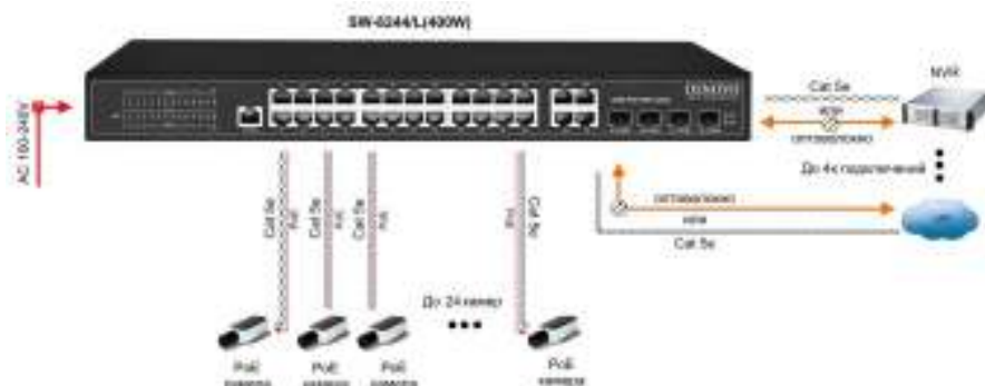
Рис.8 Типовая схема подключения коммутатора SW-8244/L(400W)
