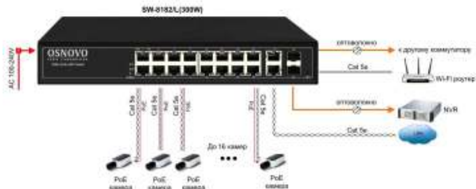
Рис.7 Типовая схема подключения коммутатора SW-8182/L(300W)
