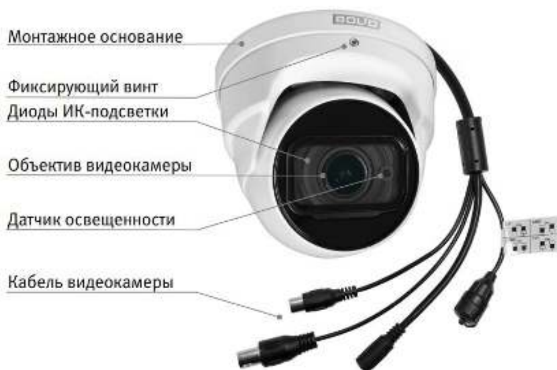
Рисунок 4.1 — Внешний вид и основные элементы видеокамеры
