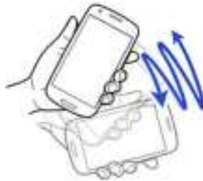
Рис. 2. Активация PW ID с помощью встроенного акселерометра
