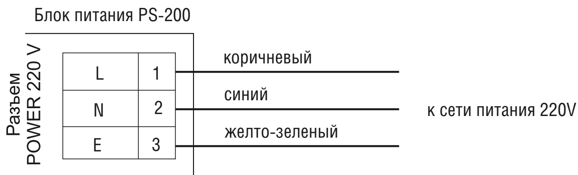
Рисунок 7.6.1 Схема подключения блока питания
