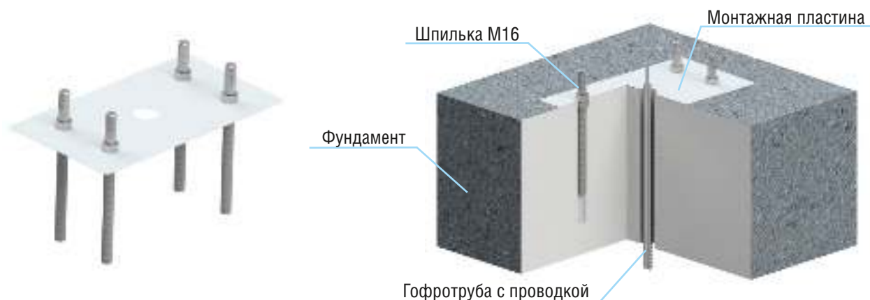
Рисунок 7.2.1 Устройство фундамента с монтажным комплектом
