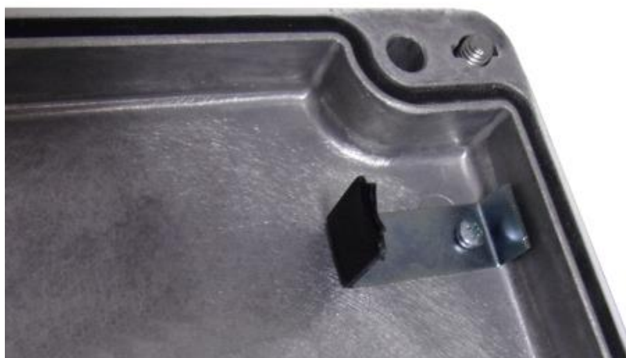
Рисунок 3.5.2 - Шторка датчика вскрытия на крышке блока
