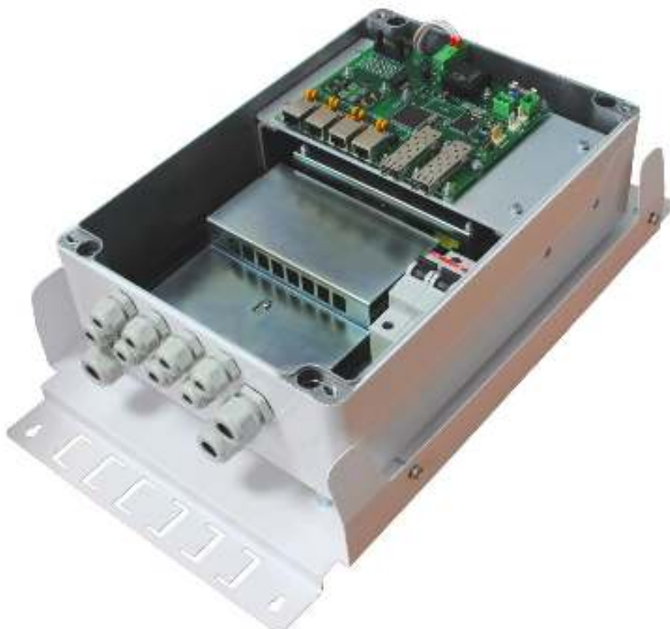
Рисунок 3.1.3 - PSW-2G+Hot - вид внутри
