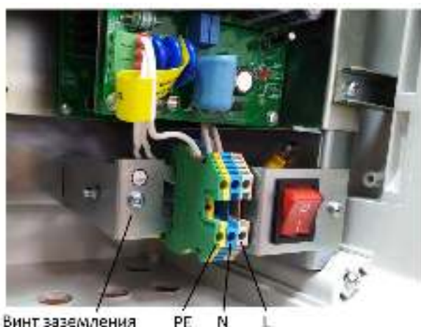
Рисунок 3.5.1 – Узел подключения питания.
