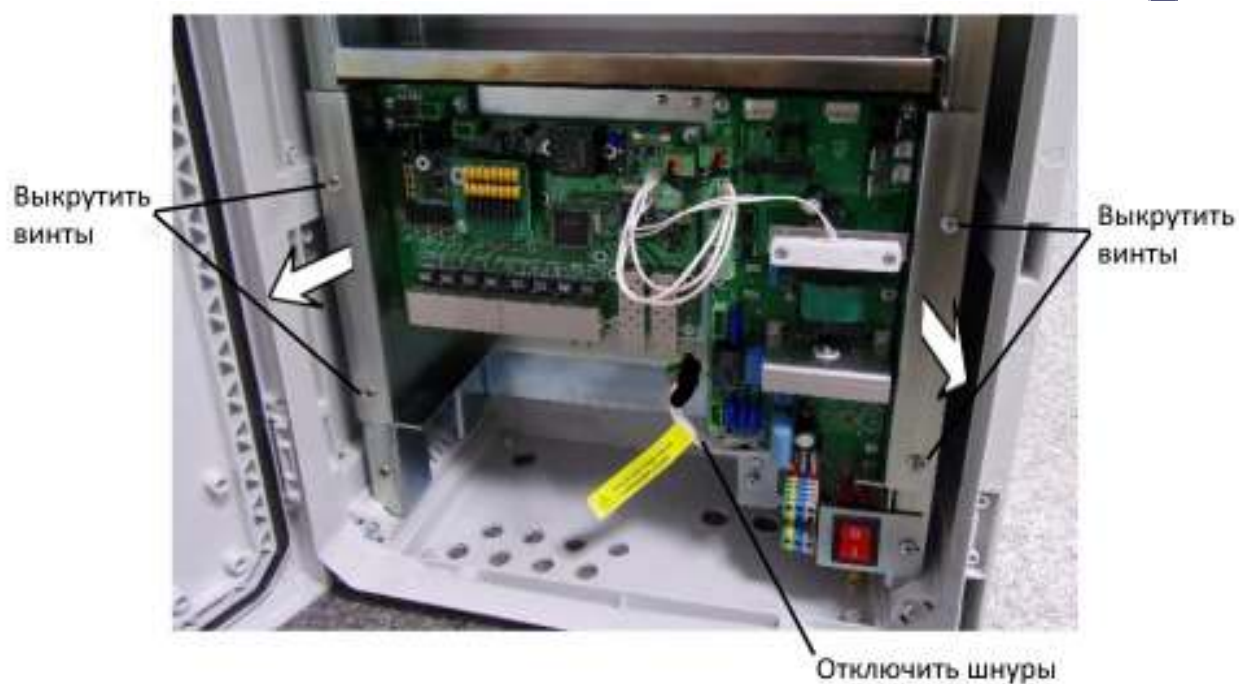
Рис. 7.1.2. Извлечение электронного узла
