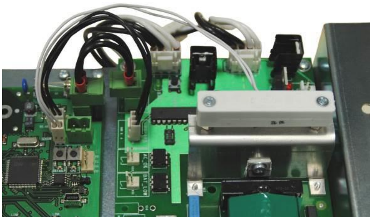
Рисунок 3.7.2 - Датчик вскрытия на корпусе коммутатора.
