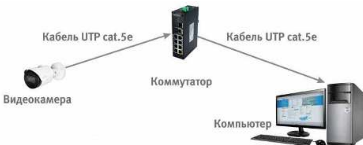
Рисунок 6.3 - Схема подключения видеокамеры к компьютеру через коммутатор
