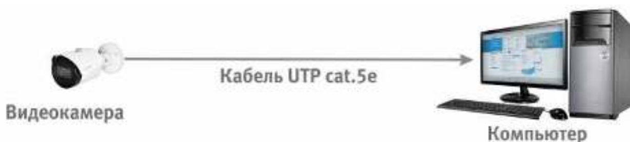
Рисунок 6.2 – Схема подключения видеокамеры к компьютеру
