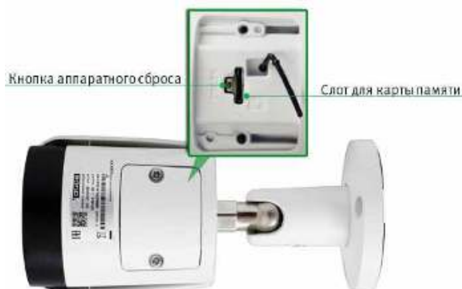
Рисунок 4.2 – Расположение кнопки аппаратного сброса и слота для карты памяти
