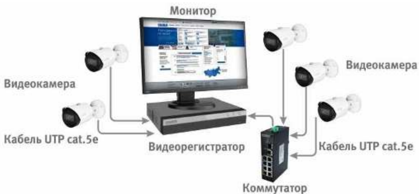
Рисунок 6.4 – Схема подключения видеокамеры к видеорегистратору
