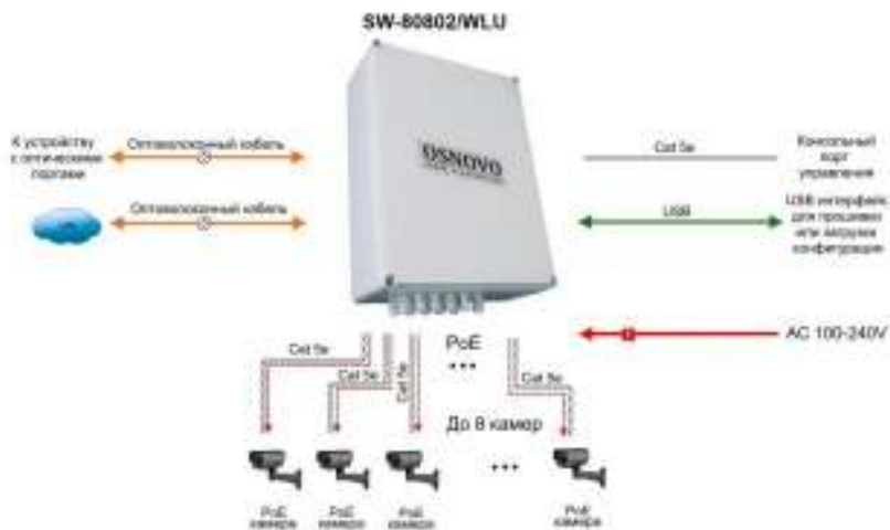
Рис.5 Типовая схема подключения коммутатора SW-80802/WLU
