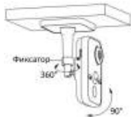
Рисунок 1.5.2 Настройка угла наблюдения камеры
