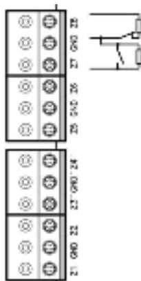
Рис.15. Подключение шлейфов блокировки и свободного прохода
