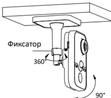
Рисунок 3-9 Регулировка угла наблюдения
