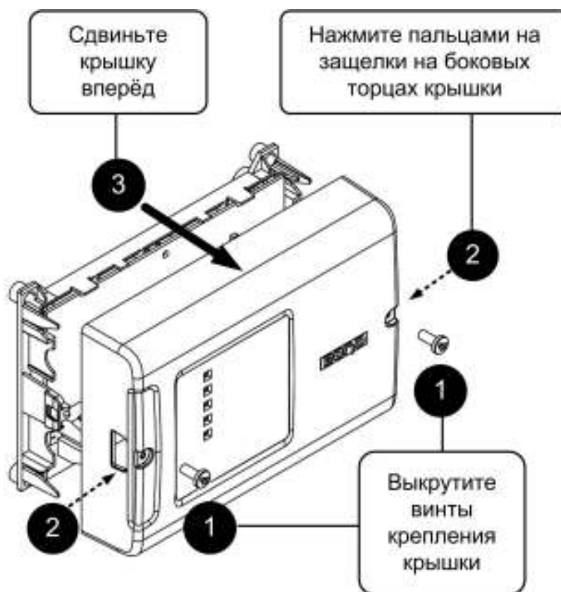
Рисунок 2.2.2 – Снятие крышки корпуса блока
