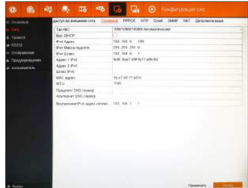
Рисунок 5.70 Основные сетевые настройки.
