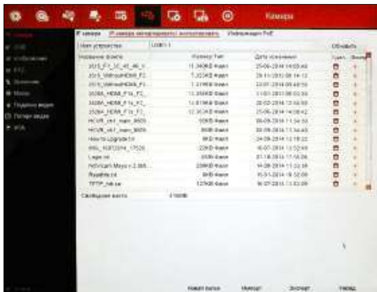
Рисунок 5.47 Экспорт/импорт настроек IP камер.
