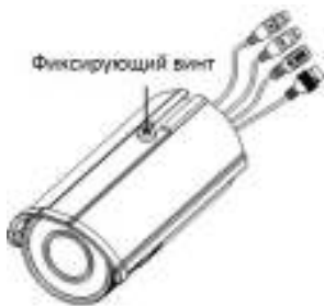
Рисунок 2-1 Удаление солнцезащитного козырька (1)
