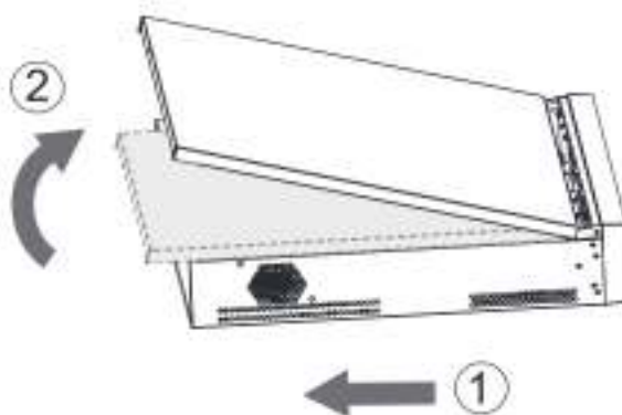
Рисунок 3.4 – Установка жесткого диска
