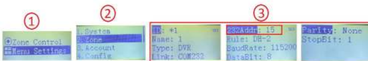
Рисунок 12.7 – Настройка контрольной точки через RS-232
