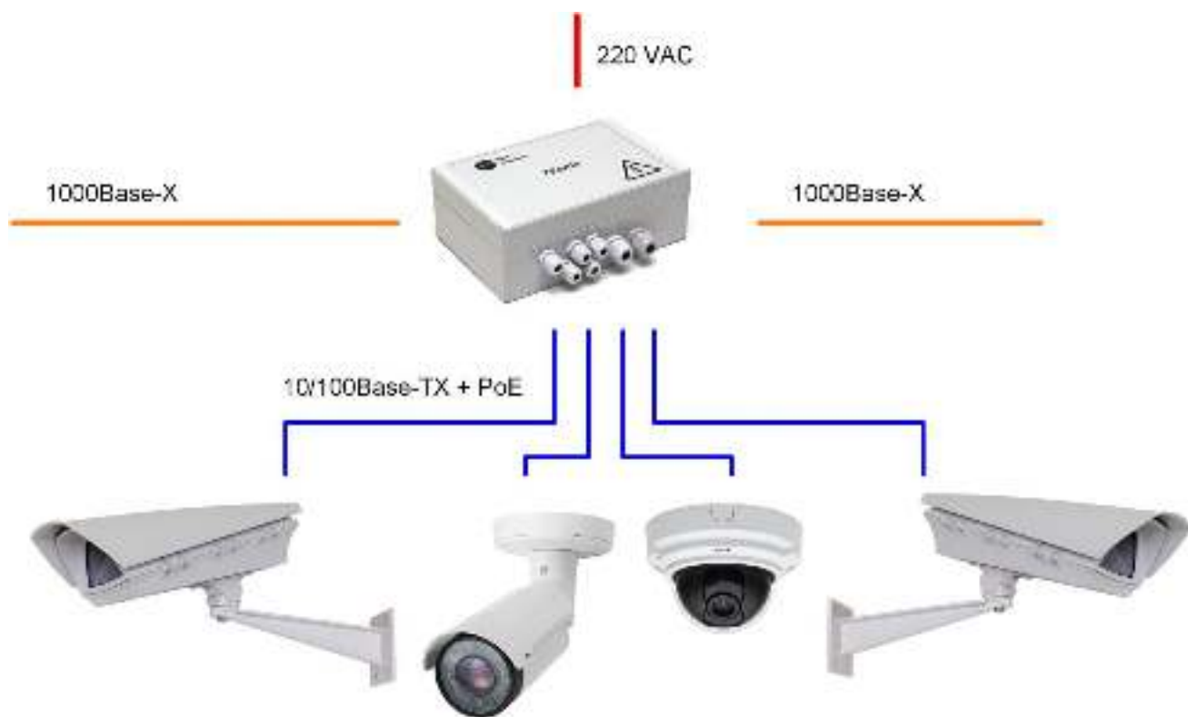
Рис. 1. Схема подключения PSW-2G4F
