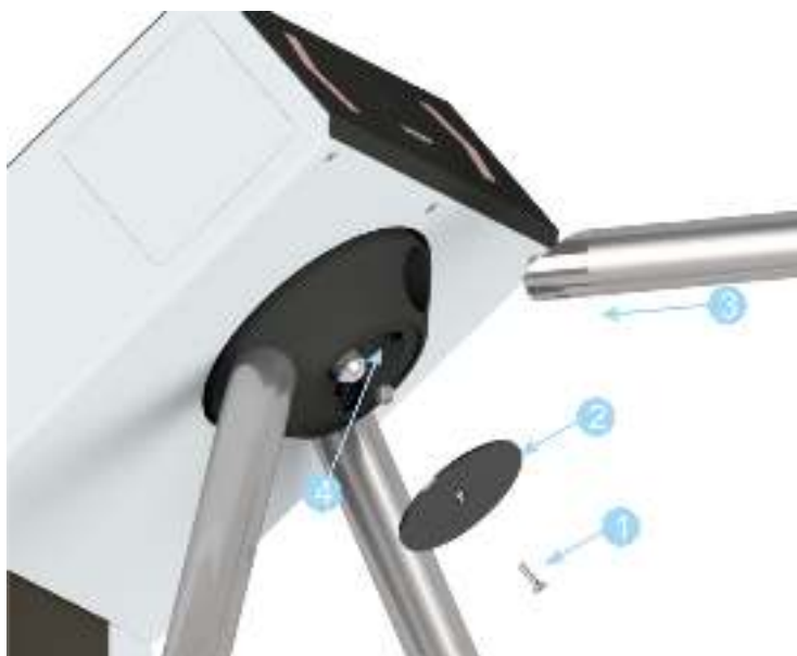
Рисунок 7.5.1 – Установка стандартной преграждающей планки.
