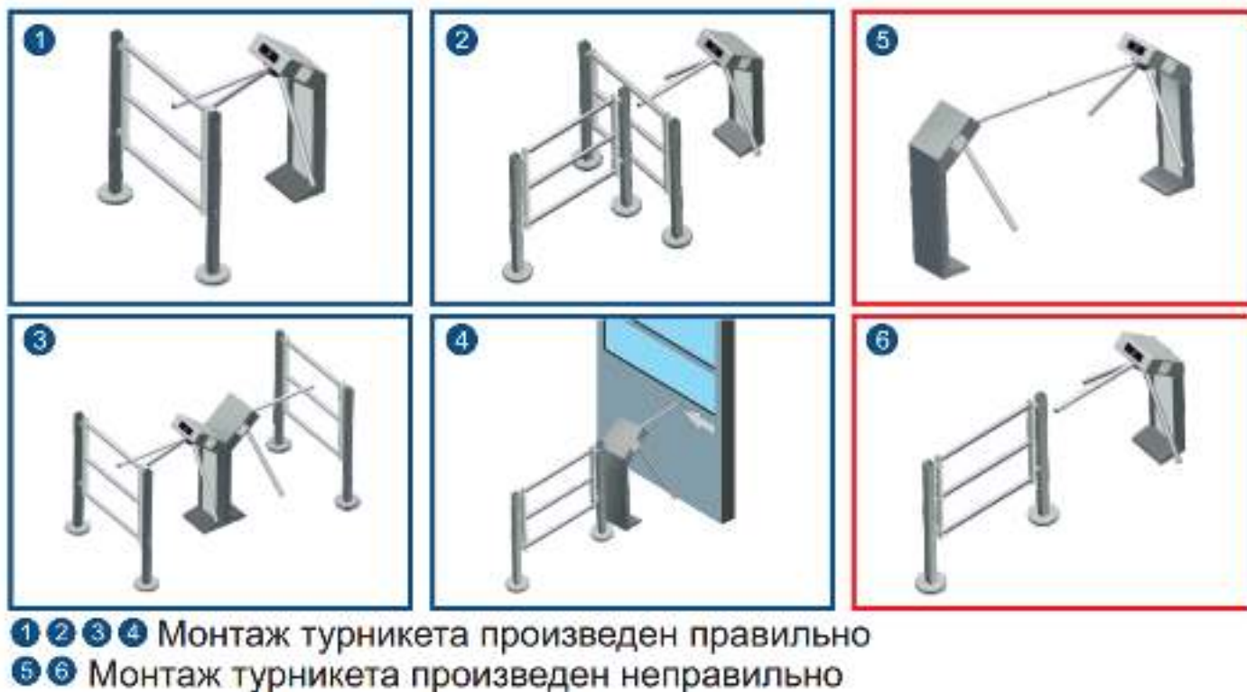
Рисунок 7.3.1 – Правильные и неправильные варианты монтажа электронной проходной.
