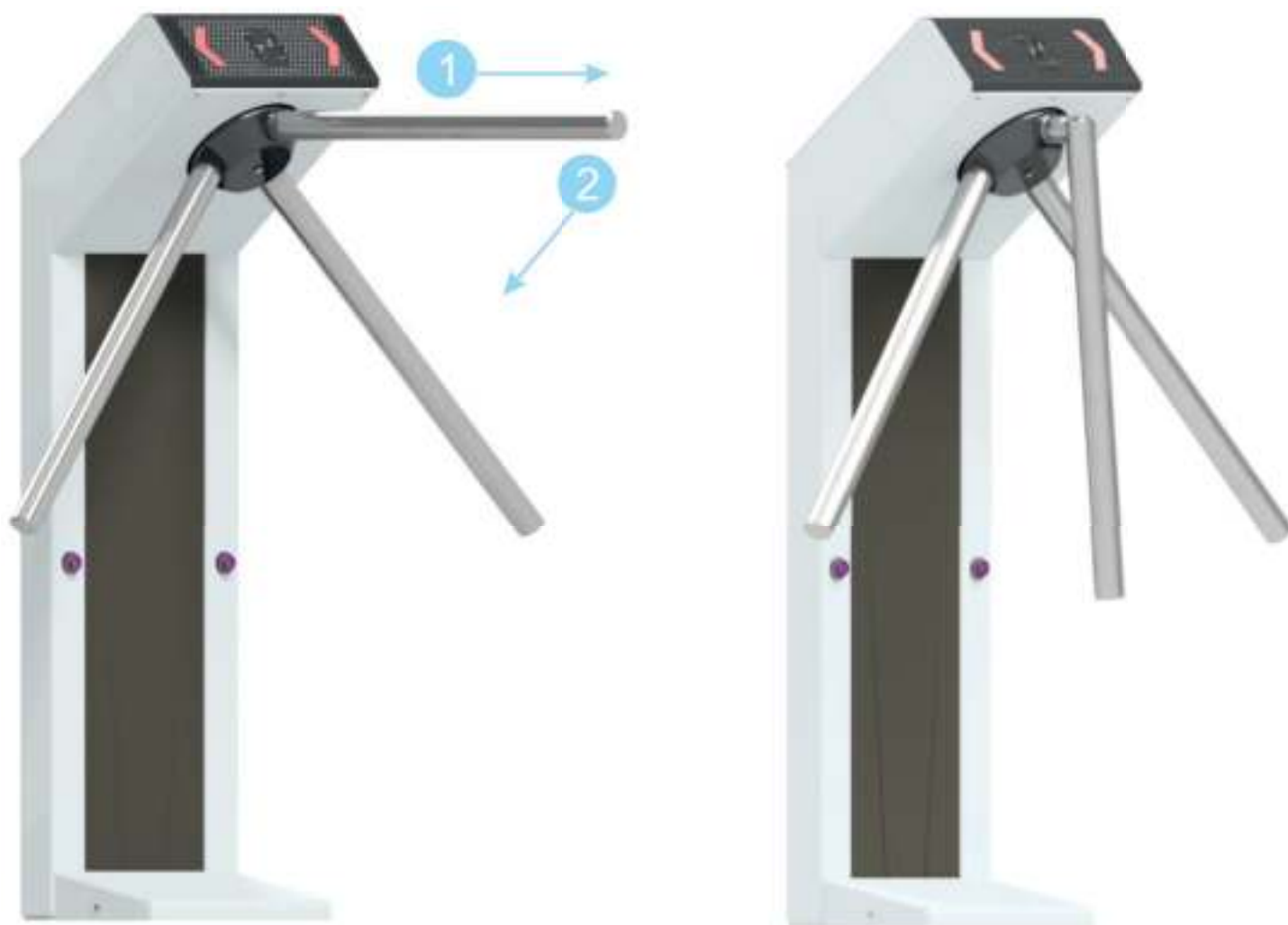
Рисунок 6.6.3 – Принцип работы планок «Антипаника».
