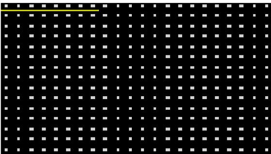
Используйте кнопки со стрелками на удаленной клавиатуре для перемещения окна выбора блока вверх, вниз, влево и вправо. Окно выбора содержит 8 блоков в каждом ряду. С помощью кнопок **Камера** можно выделять (и снимать выделение) отдельные блоки. Для перемещения области можно использовать мышь, а затем выбрать, очистить или инвертировать выбор.
