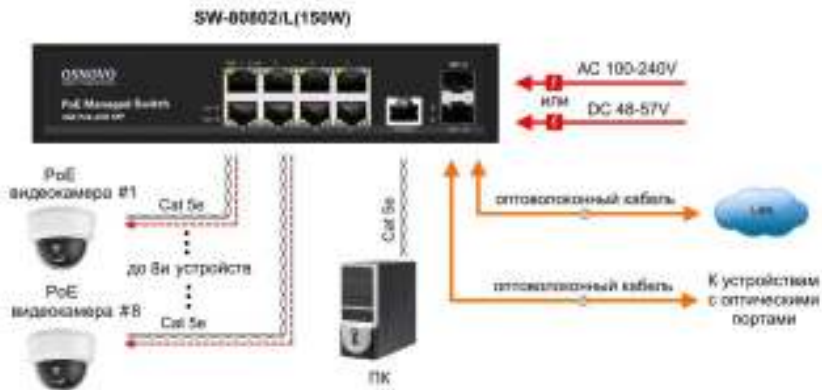
Рис.3 Типовая схема подключения коммутатора SW-80802/L(150W)
