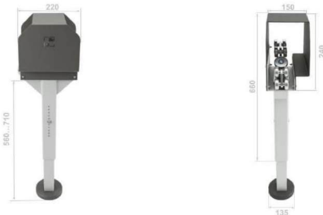
Рисунок 25. Габаритные размеры стрелоуловителя BSR-02
