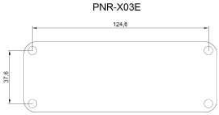
Рисунок 2. Расположение крепежных отверстий на плате считывателя
